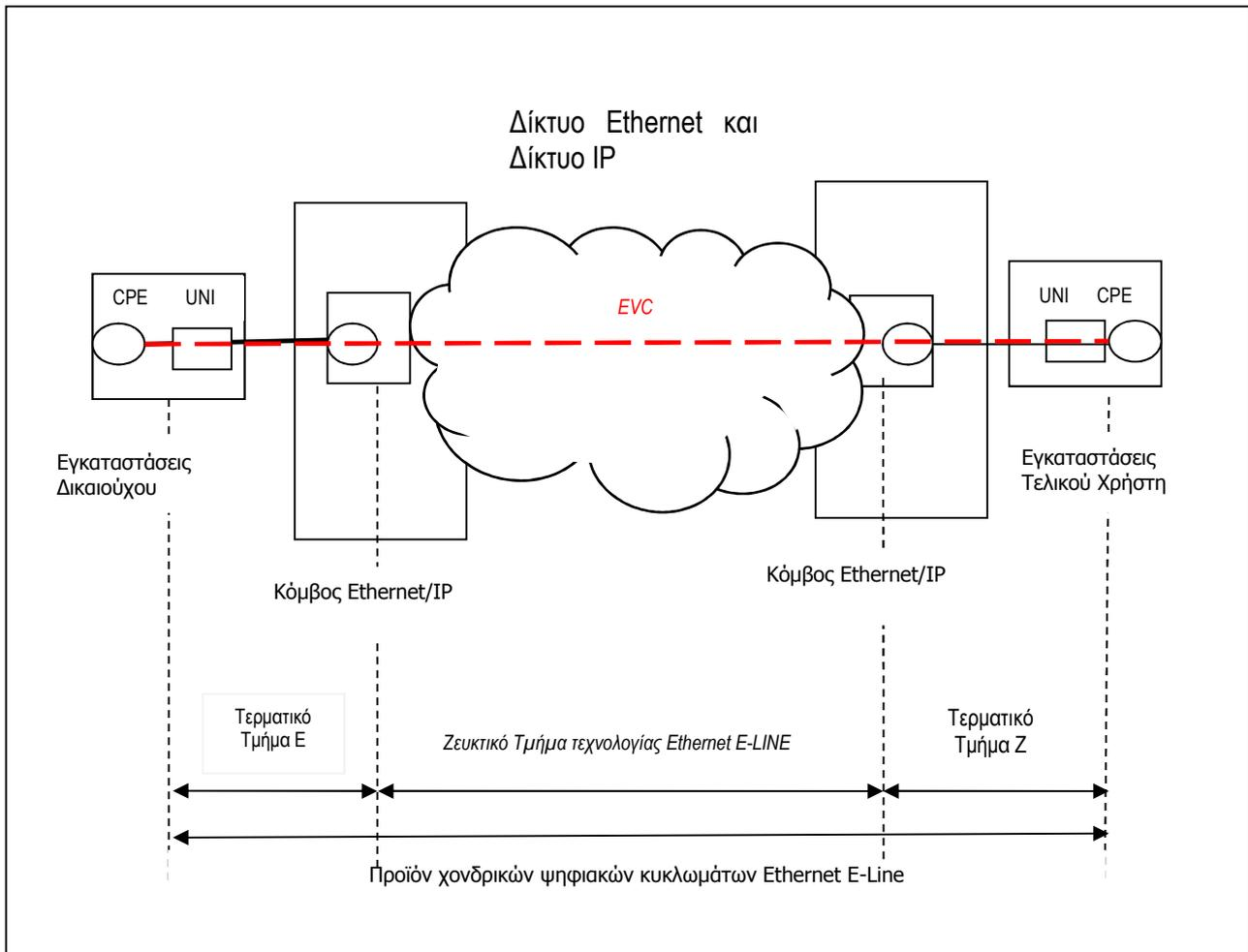
Σχήμα 3.1: Προϊόν Χονδρικών Ψηφιακών Κυκλωμάτων Ethernet E-line
