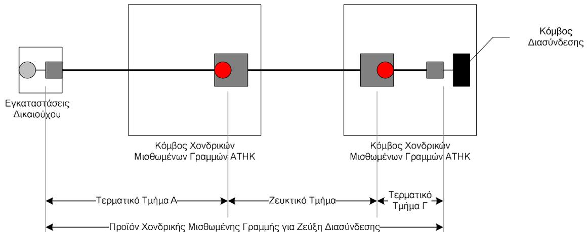
Σχήμα 2.1: Προϊόν Χονδρικής Μισθωμένης Γραμμής για Ζεύξη Διασύνδεσης με χρήση Τερματικού Τμήματος Α.
