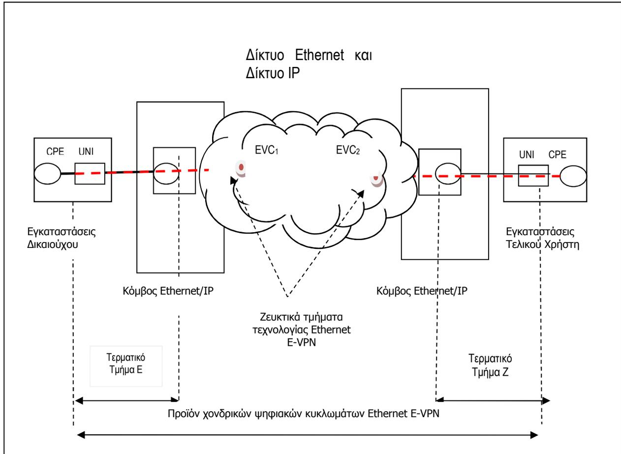
Σχήμα 3.2: Προϊόν Χονδρικών Ψηφιακών κυκλωμάτων Ethernet E-VPN.
