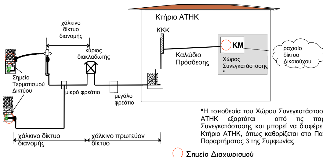
Σχ. 1-2: Πλήρως Αδεσμοποίητη Πρόσβαση στον Τοπικό Βρόχο
