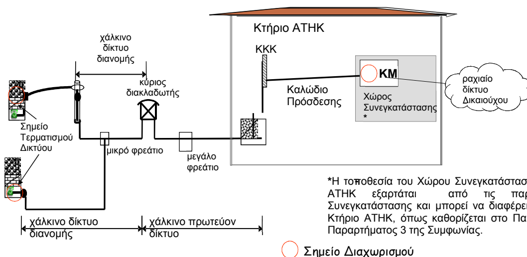
Σχ. 1-2: Πλήρως Αδεσμοποίητη Πρόσβαση στον Τοπικό Βρόχο
